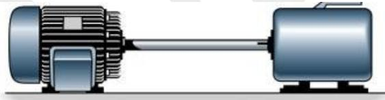
Dados do eixo: Comprimento  $L = 3$  m, Módulo de elasticidade ao cisalhamento  $G = 75$  GPa e momento polar de inércia da sessão transversal  $J = 6 \times 10^{-7}$  m<sup>4</sup>. ( $\pi = 3$ ).
